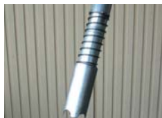
〈吸入口バネ(伸縮機構型サクシヨンパイプ)〉
