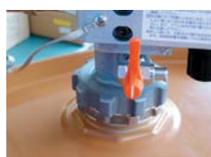
〈エア抜きバルブ〉 ドラム缶内のエア を抜く時に使用。
